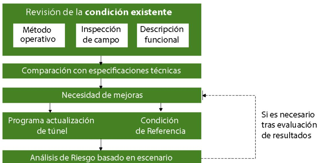
*Ilustración 25 – Ejemplo de proceso en túneles en servicio para definir un nivel aceptable de seguridad, aplicando un análisis de riesgo basado en el escenario*
